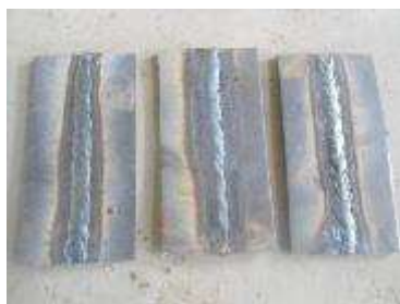
Gambar 6. Hasil Praktek Membuat Sambungan I
